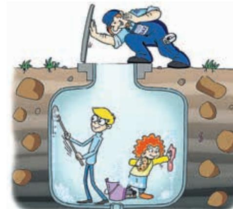
Zum Reinwasser wird das Rohwasser nach seiner technischen Aufbereitung im Wasserwerk. Da die Prozesse im Wasserwerk nicht kontinuierlich ablaufen, sondern immer bestimmte Mengen auf verschiedenen „Stationen“ (z. B. Enteisenung, Belüftung usw.) verweilen, ist ein Reservoir zur Aufnahme des behandelten Wassers nötig – der Reinwasserbehälter. Von dort aus gelangt das Trinkwasser über das Netz an die Verbraucher.
